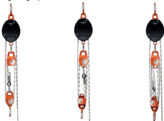
HỆ THỐNG RÒNG RỌC GORDON 1:3 A-120-3+ L-0741-Chiều dài (R-064) Dây Semi-static 10.5 mm Chiều dài dây dài tương đương với 3 lần độ cao cần nâng
